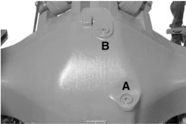
Limpiar alrededor de tapón de vaciado/llenado del eje trasero.
